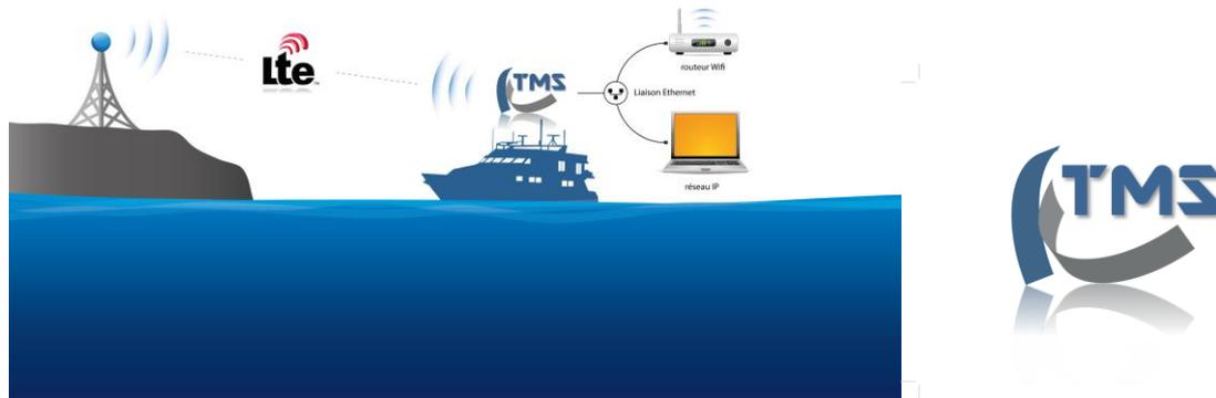
Le TMS, Terminal Marine Stabilisé, est composé d'un émetteur récepteur et de 2 modèles d'antennes selon la portée désirée et la taille de l'embarcation. La plus puissante vise les bateaux de grande dimension car elle permet de réorienter en permanence le faisceau de l'antenne afin d'accroître sa portée. L'autre est plus simple, ce qui la rend accessible financièrement aux plaisanciers.
