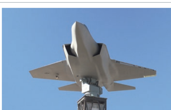
Base extérieure de mesures champ lointain pour l'Industrie Aérospatiale
