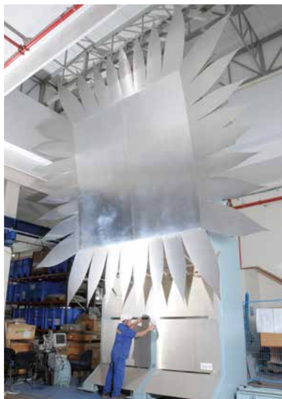
Réflecteur de base compacte avec serrations en cours d'assemblage
