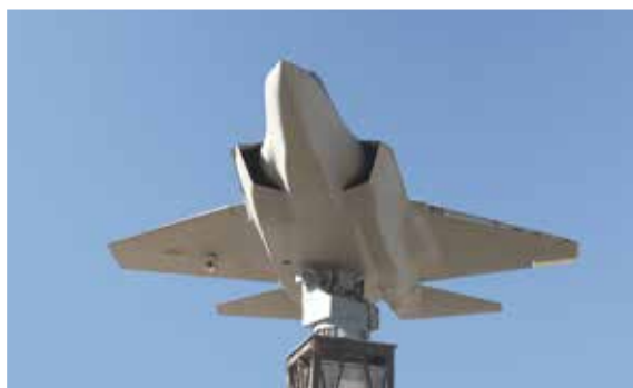
Base extérieure de mesure champ lointain pour l'Industrie Aérospatiale
