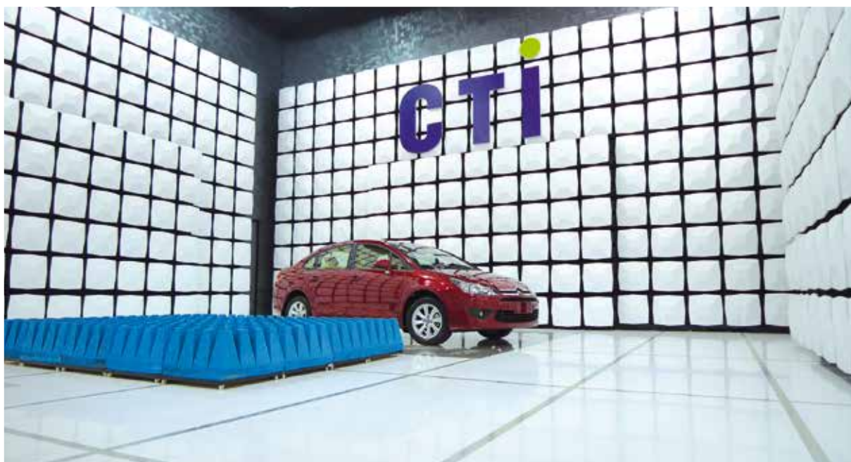
Chambre de mesure EMC 10 m pour l'Industrie Automobile
