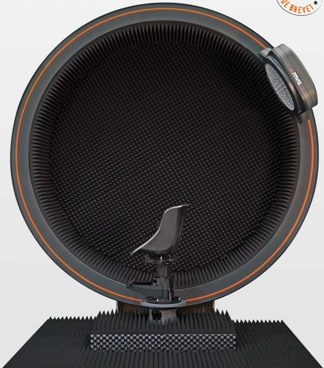
**MVG commercialise une nouvelle génération de solutions de tests OTA adaptée aux fréquences milimétriques de la 5G, associant un positionnement mécanique intelligent à des générateurs d'onde plane (PWG) afin de créer des conditions de champ lointain indirect précises, le tout dans un système compact.**
